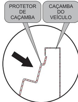
3. Posicione o protetor de caçamba "A" no veículo conforme indica as figuras, para encaixar as laterais do protetor é necessário puxar a parte central do protetor e pressionar as laterais encaixando-as em baixo das bordas laterais da caçamba.
